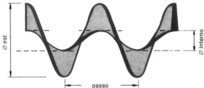
LE SPIRALI IN CONTINUO VENGONO REALIZZATE PER LAMINAZIONE DA NASTRI DI ACCIAIO O ACCIAIO INOX.
